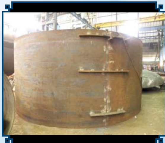
Shell Long seam Fitup
